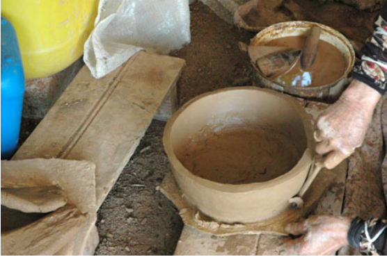
Foto 27: Kıylık malası/göt kesici ile gövecin taban kenarının düzeltilmesi
