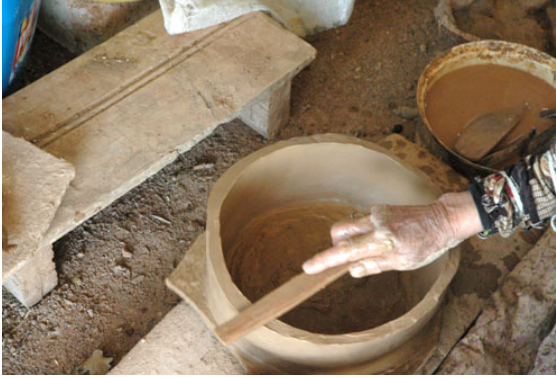
Foto 26: Şıp şıp malası ile üst yüzeyin düzeltilmesi
