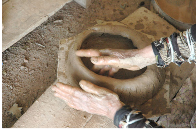
Foto 22: Zeliha Teyze; eli ile yanlık ve tabanı birleřtiriyor. Yine el yardımıyla iç kısımları düzeltiyor.
