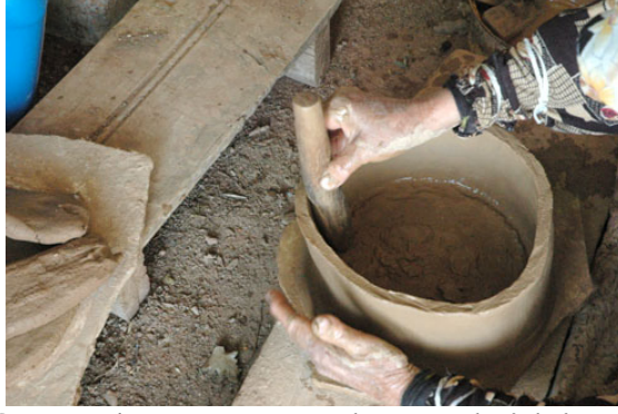
Foto 25: Onargeç/ onarma malası ile gövecin içinin düzeltilmesi
