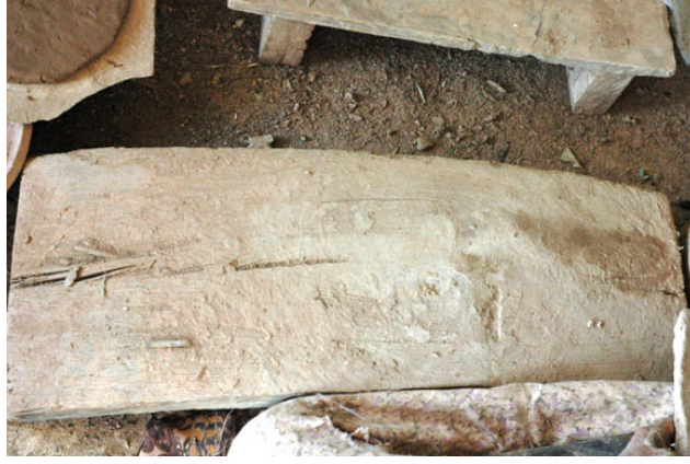
Foto 13: Yastıgaç/Mala tahtası: Eski düven başından yapılır. Yanlık çamurunun şekillendirilmesinde kullanılır.
