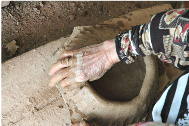
Foto 21: Zeliha Teyze; eli ile yanlık ve tabanı birleştiriyor. Yine el yardımıyla iç kısımları düzeltiyor.
