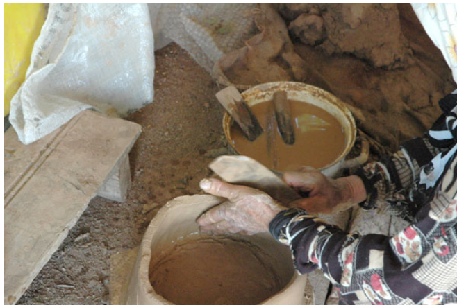
Foto 24: Mala ile gövecin dışının düzeltilmesi
