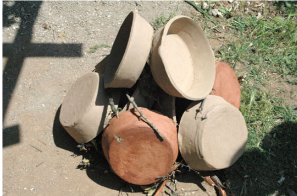
Foto 35: Sırlanan göveçler, aralarına kuru pelit dalları ve pelit yaprakları yerleştirilerek açık havada yaklaşık bir saat kadar pişirilir. Bu pişirme işine “gappeş” adı verilir.
